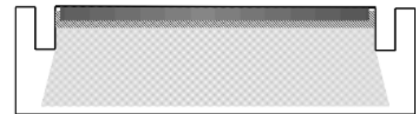
(d) Remove contacts and diffuse second, shallower Li layer
